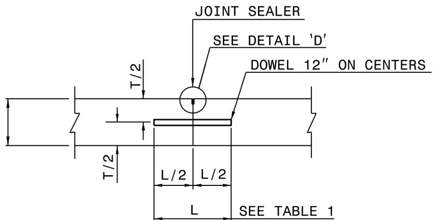
**PLANNED TRANSVERSE CONSTRUCTION JOINT**
