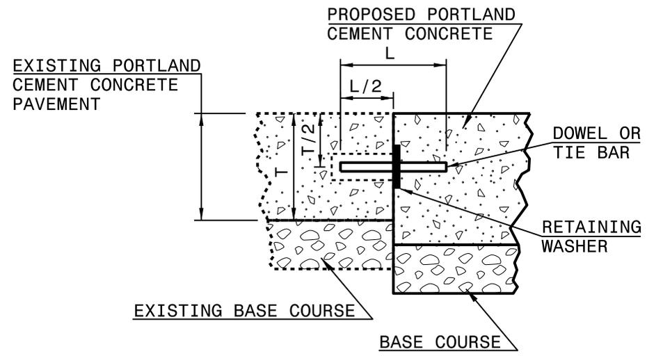
**LONGITUDINAL OR TRANSVERSE SECTION 'A-A'**
