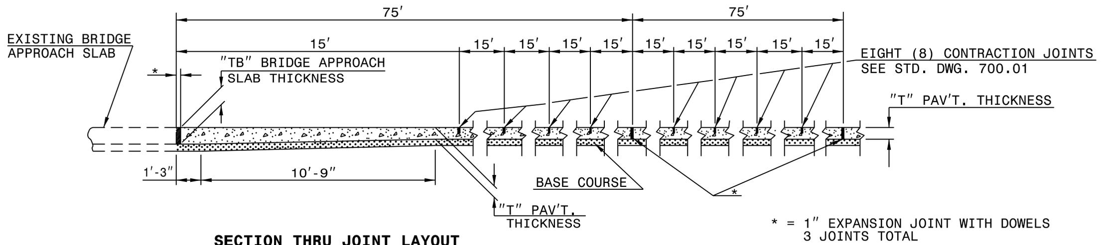
**SECTION THRU JOINT LAYOUT**
