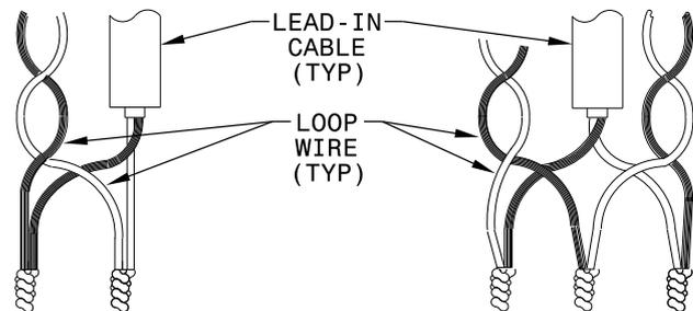
STEP 3. INSULATE EACH SOLDER JOINT SEPARATELY
