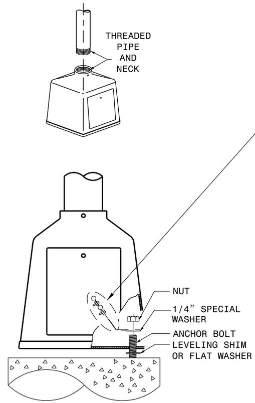
**TRANSFORMER BASE ANCHORING DETAIL**
